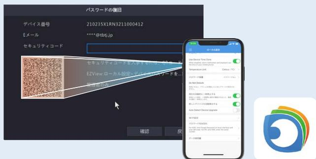
ログイン画面の「パスワードをお忘れですか」をクリックすると QR コードが表示されますので、スマートフォンアプリ「EZView」を起動し「ローカル設定」>「パスワードお忘れ」の項目より QR コードをスキャンすると再発行の手続きが行えます。
