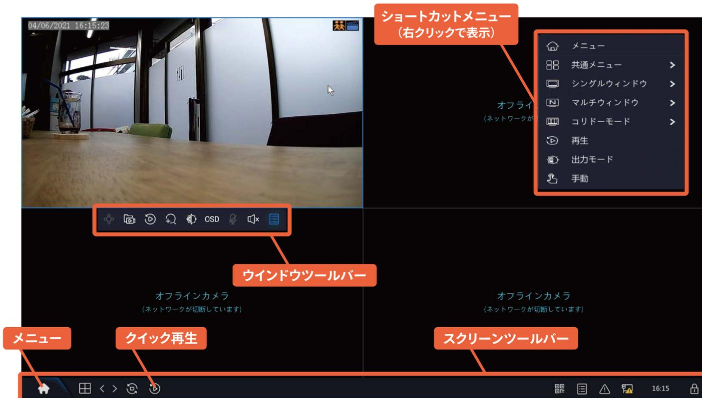
※カメラ映像をダブルクリックすると画面がフルスクリーンになります。戻す際もダブルクリックをします。
