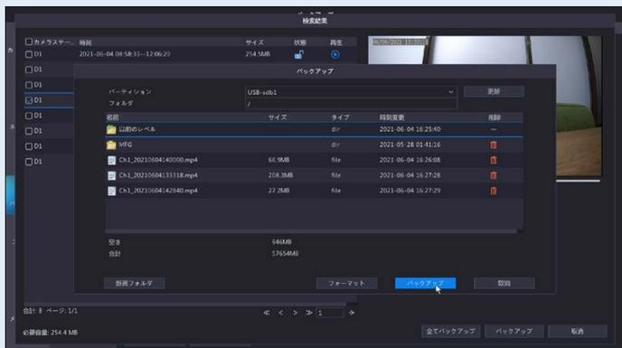
④ 保存する USB デバイスを「パーティション」で確認し、保存フォルダを指定して「バックアップ」をクリックします。
