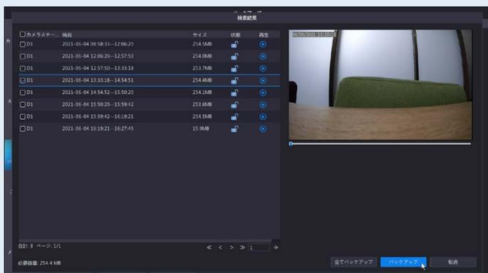
③ 検索されたファイルの中からバックアップしたいデータにチェックを入れ、バックアップをクリックします。「すべてをバックアップ」をクリックすると、検索されたデータを全てバックアップします。
